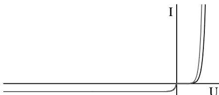
Abbildung 1: Strom-Spannungs-Kennlinien einer Diode nach Gleichung 1.1 für zwei verschiedene Temperaturen ( $10^\circ\text{C}$  und  $50^\circ\text{C}$ ); der Strom im Sperrbereich ist um  $10^4$  überhöht dargestellt.
