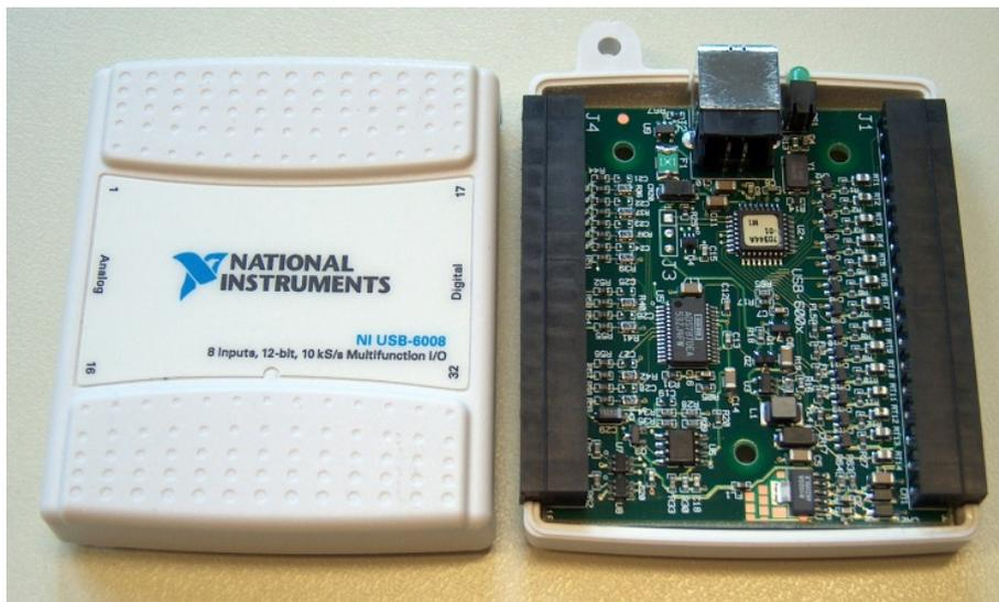
Abbildung 81: Innenansicht des NI USB-6008, oben die USB-B-Buchse zum Anschluss an den PC.
