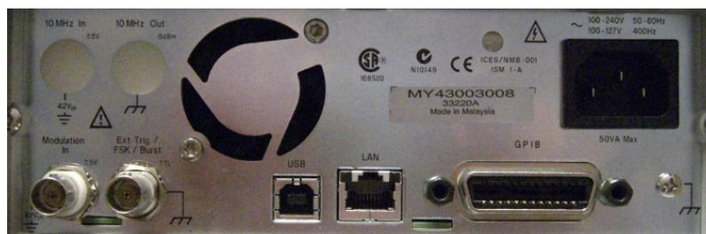
Abbildung 97: Rückseite eines Messgeräts (Agilent Funktionsgenerator 33220A): Noch sind drei Standards, USB, LAN und GPIB, als Anschlussmöglichkeiten vorgesehen.
