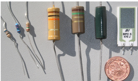
Abbildung 3.1: Beispiele für verschiedene Ohmsche Widerstände, die 1 Cent Münze dient als Größenvergleich. Links drei 1/4 Watt Widerstände, daneben zwei Widerstände für höhere Leistungen. Die beiden Widerstände rechts sind Hochleistungswiderstände in konventioneller Bauform sowie als Metallfilm auf einer Keramikplatte (gute Wärmeabfuhr).
