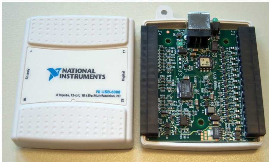
Abbildung 10.12: Innenansicht des NI USB-6008, oben die USB-B-Buchse zum Anschluss an den PC.
