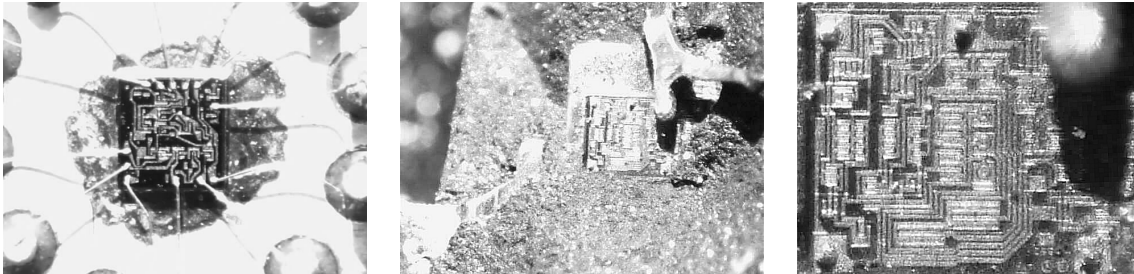
Abbildung 8.5: Integrierte Schaltungen um 1970 (links) und etwa 15 Jahre später (Mitte in gleicher Vergrößerung, rechts in höherer Vergrößerung).
