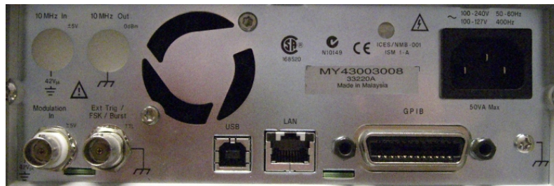
Abbildung 10.28: Rückseite eines Messgeräts (Agilent Funktionsgenerator 33220A): Noch sind drei Standards, USB, LAN und GPIB, als Anschlussmöglichkeiten vorgesehen.
