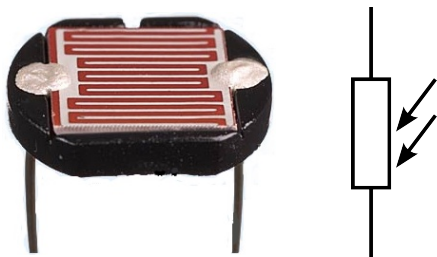
Abbildung 5.13: Bauform (links) und Schaltsymbol (rechts) für einen Photowiderstand. Beim dargestellten CdS-Photowiderstand befindet sich die lichtempfindliche amorphe oder polykristalline Halbleiterschicht zwischen den kammartigen Metallkontakten.
