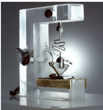
Abbildung 1.1: Nachbau des ersten Transistors aus Germanium (links) und die ursprüngliche Verstärkerschaltung (Auszug aus dem Laborbuch von Brattain).
