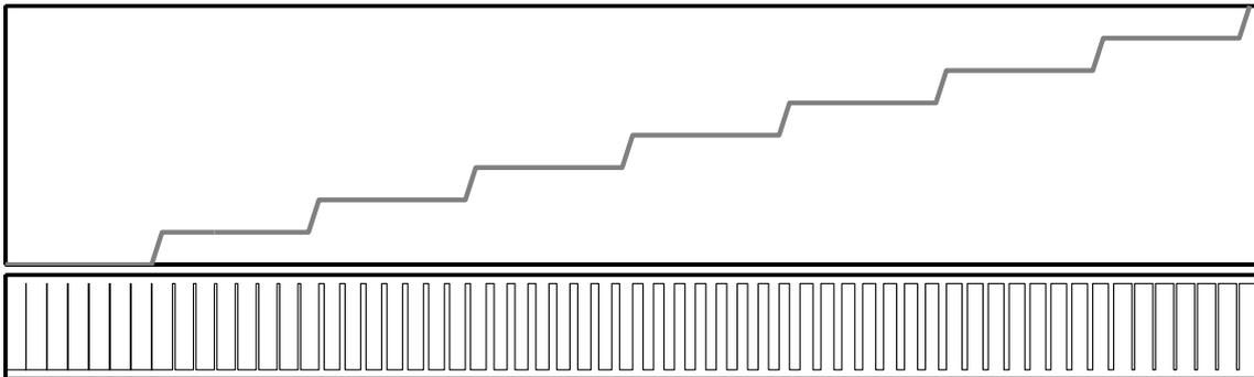
Drei Bit Genauigkeit: Oben die analoge Repräsentation der Digitalwerte 000 bis 111, unten die zugehörigen pulswertenmodulierten Signale.
