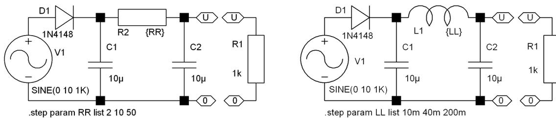
Abbildung 6.2: Siebketten zur Glättung von pulsierender Gleichspannung, links mit zwei Kondensatoren und Widerstand, rechts mit Spule.
