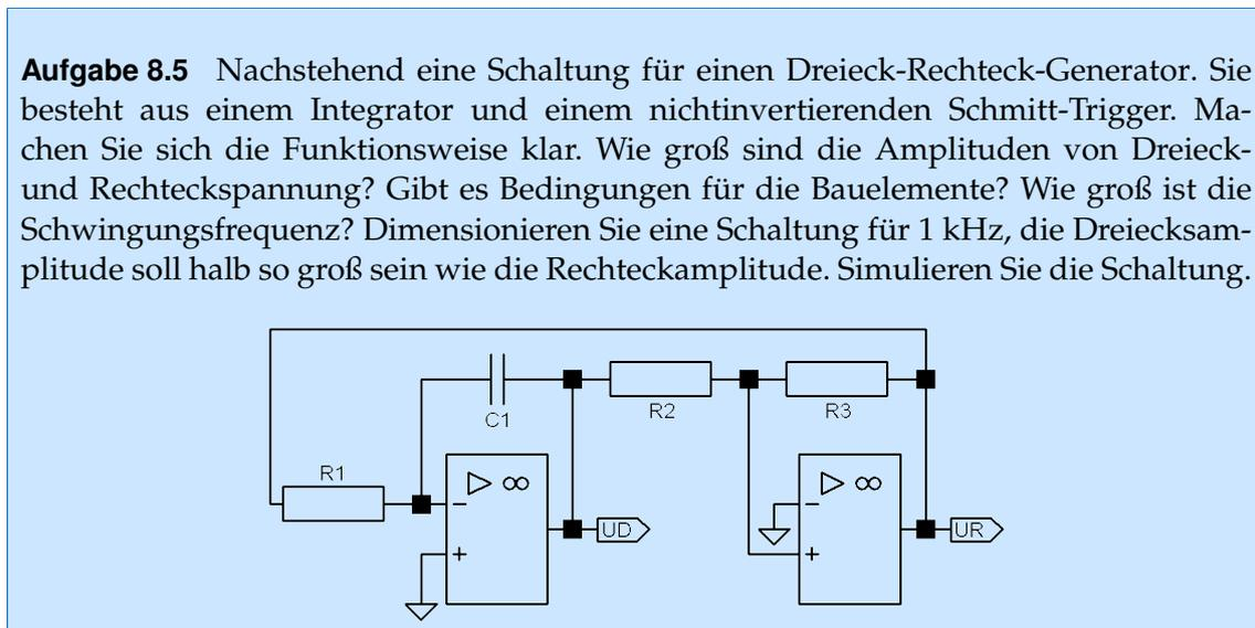
Die Amplitude der Rechteckspannung ist die Ausgangsamplitude des Schmitt-Triggers also etwas weniger als die Betriebsspannung. Der Schmitt-Trigger kippt immer dann, wenn die Spannung am nichtinvertierenden Eingang durch Null geht. Dafür gilt
