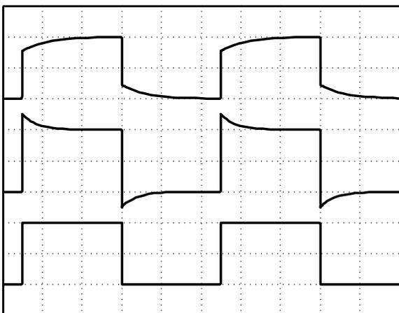
**Aufgabe 4.4 Tastkopf, LTspice** Gleiche Aufgabe, aber Lösung mit LTspice. Verhalten bei unterschiedlichen Frequenzen der Rechteckspannung? Bode-Diagramm der Übertragungsfunktion für die unterschiedlichen Werte von C2 Können Sie Ihre Vermutungen aus Aufgabe 3.6 bestätigen?
