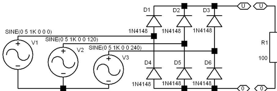
Abbildung 6.1: Schaltbild für die Simulation von Drehstrom und Drehstromgleichrichtung.
