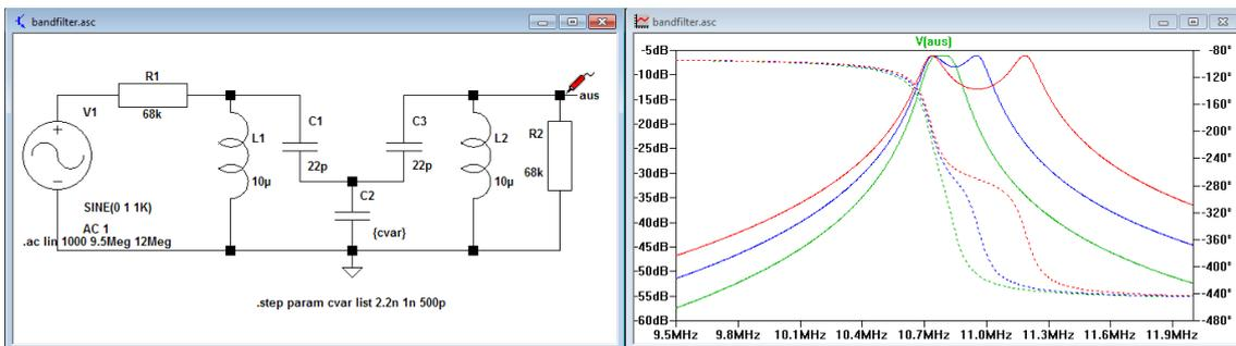
Gleichphasige Schwingung: Die Koppelkapazität C3 verringert die effektiven Kapazitäten, Verschiebung zu höheren Frequenzen mit stärkerer Kopplung.
