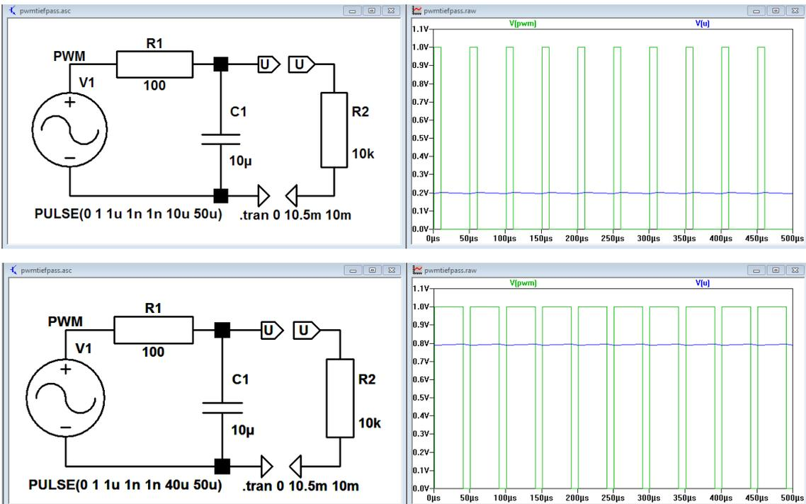
Oben ein pulswertenmoduliertes Signal mit einem Puls-Perioden-Verhältnis von 1:5, die mittlere Ausgangsspannung ist 0.2 V, ein Fünftel der Pulsamplitude. Unten 4:5, die mittlere Ausgangsspannung wird 0.8 V, vier Fünftel der Pulsamplitude.
