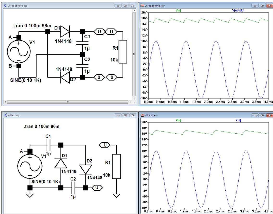
**Aufgabe 6.6 Spannungsvervielfachung** Eine der beiden Verdopplerschaltungen, die Villard-Schaltung, kann kaskadiert werden, um noch höhere Gleichspannungen zu erzielen. Eine Kaskade aus drei Villards ist in Abbildung 6.4 skizziert. Diskutieren Sie die Schaltung und untersuchen Sie die Funktion mit LTSpice. Was müsste man ändern, um die ungeraden Vielfachen  $U_1, U_3, U_5$  verwenden zu können?
