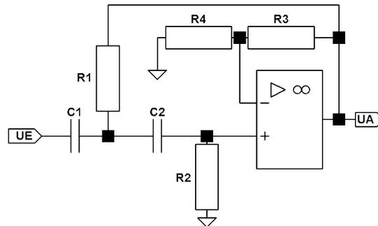
Die Verstärkung  $K$  des Operationsverstärkers wird durch  $R_3$  und  $R_4$  eingestellt
