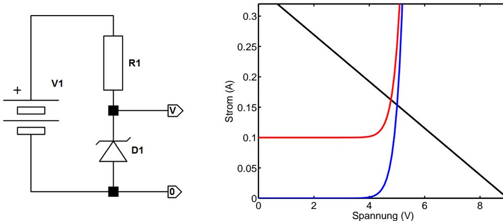
Links die Schaltung, rechts die graphische Lösung der Knotengleichung am Knoten  $V$ . An diesem Knoten gilt
