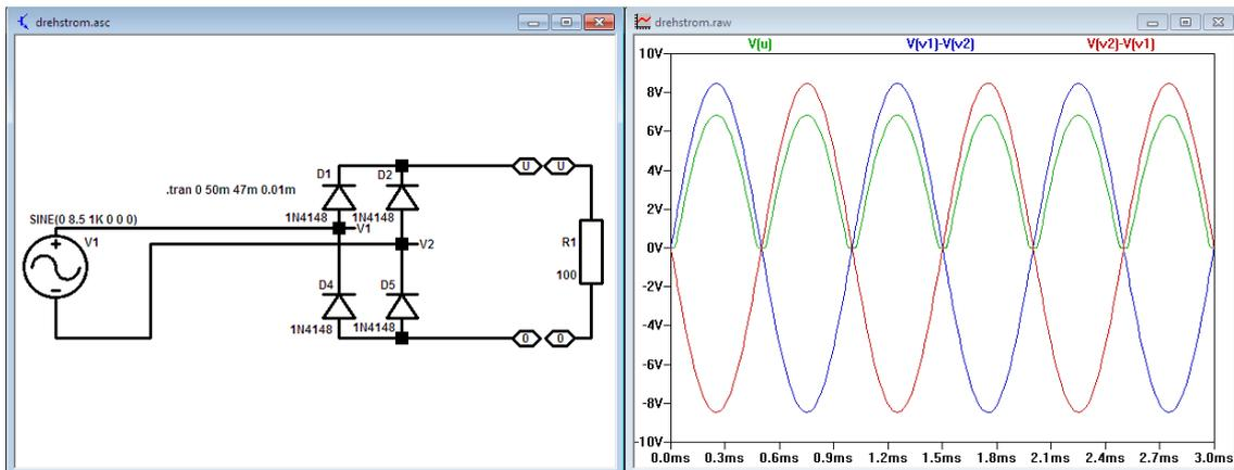
**Aufgabe 6.4 Siebkette** Die durch Gleichrichtung gewonnene pulsierende Gleichspannung kann durch eine *Siebkette* geglättet werden. Untersuchen Sie die Wirkungsweise am Beispiel der Schaltungen in Abbildung 6.2. Stellen Sie insbesondere auch die Spannung an der Diode dar, wie groß wird die maximal?
