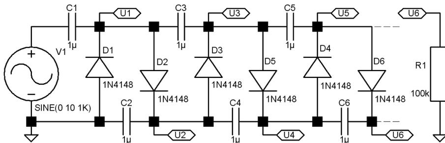
Abbildung 6.4: Spannungsvervielfacherschaltung: Kaskadierung von drei Villard-Schaltungen.
