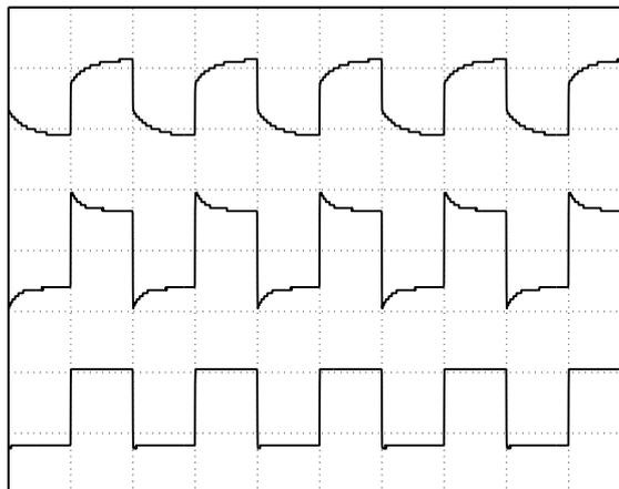
Oszilloskopbild der Rechteckspannung für zu großes  $C_2$  am Tastkopf (oben), zu kleines (Mitte) und richtig eingestelltes (unten).
