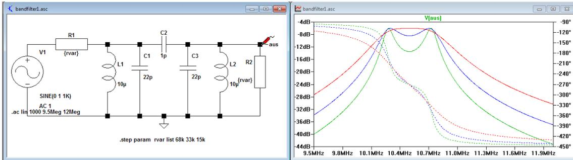
**Aufgabe 4.8 Bandfilter, modifiziert** Die Kopplung der beiden Schwingkreise kann auch so wie nebenstehend dargestellt kapazitiv realisiert werden. C3 ist dann etwa um den gleichen Faktor größer zu wählen wie es bei der anderen Kopplungsart kleiner gewählt wurde. Wie ändert sich das Bode-Diagramm? Begründen Sie das über die Größe der effektiven Kapazitäten bei gleichphasiger und gegenphasiger Schwingung der beiden Schwingkreise.
