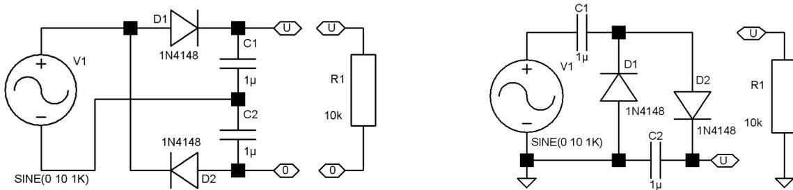
Abbildung 6.3: Spannungsverdopplerschaltungen, links: Delon-Schaltung, rechts: Villard-Schaltung.
