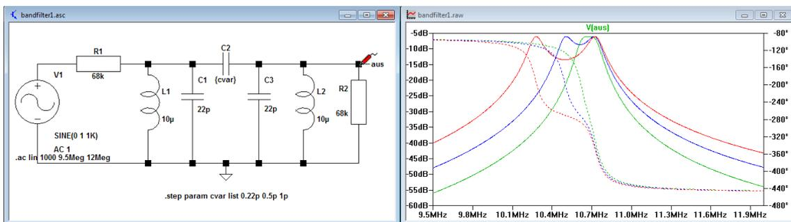
Gleichphasige Schwingung: Die Koppelkapazität  $C3$  hat keinen Einfluss auf die effektiven Kapazitäten.
