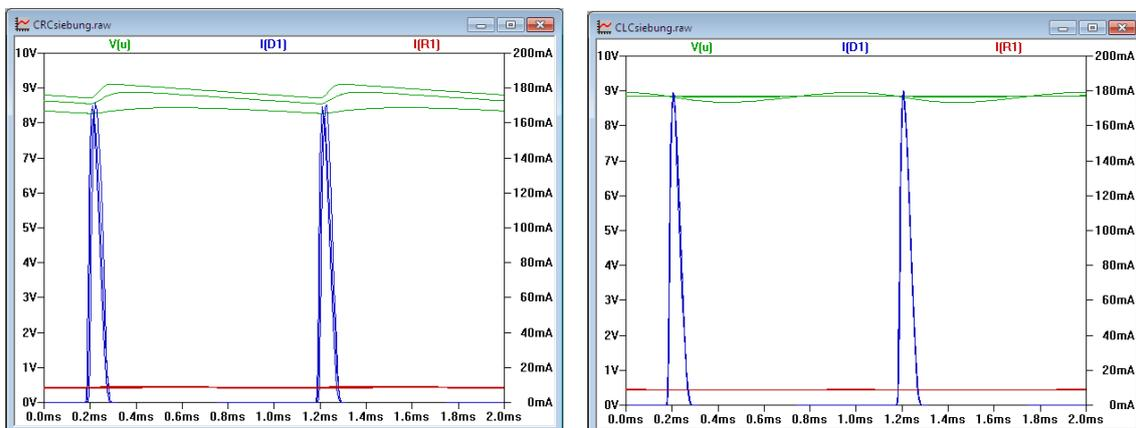
Man erkennt, dass die Siebung mit einer Induktivität deutlich wirkungsvoller ist. Weiterhin fällt auf, dass der Spitzenstrom – I(D1) – wesentlich größer als der mittlere Laststrom – I(R1) – ist.
