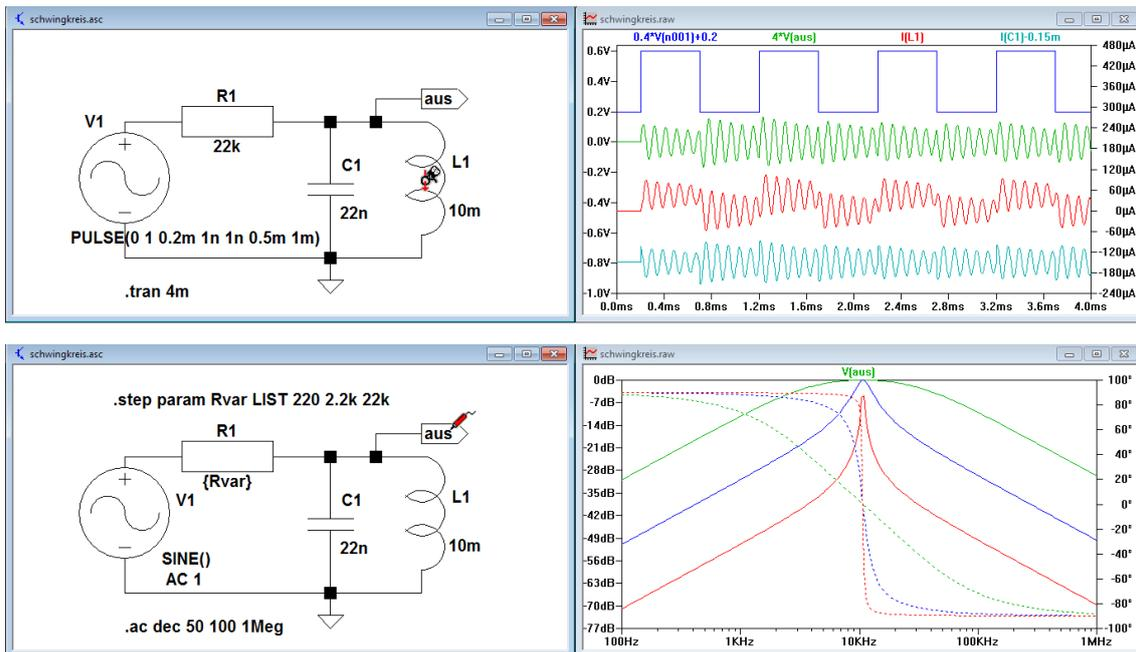
**Aufgabe 4.7 Bandfilter** Implementieren Sie die Schaltung für die beiden gekoppelten Schwingkreise (Abbildung 3.21) in LTSpice und berechnen Sie das Bode-Diagramm. Welche Wirkung hat eine Änderung der Dämpfung ( $R1, R2$ ), welche Wirkung eine Änderung der Kopplung ( $C3$ )?
