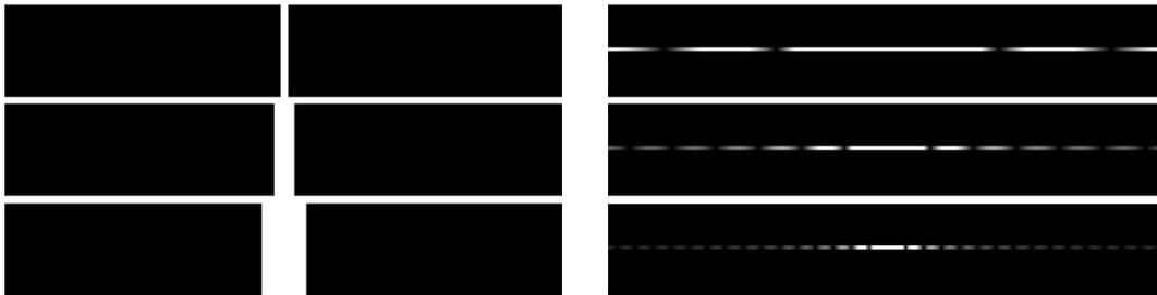
Abbildung 10: Beugung am Spalt, links die unterschiedlichen Spaltbreiten, rechts die zugehörigen Beugungsbilder.
