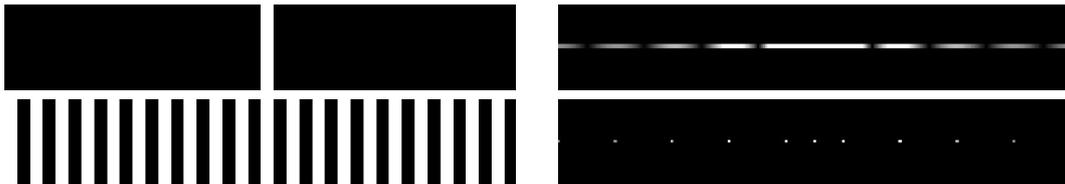
Abbildung 23: Spaltbreite gleich halber Gitterkonstante: Die Minima der Spaltbeugungsfunktion (oben rechts) entsprechen den Maxima der Ordnung  $N = \pm 2, \pm 4, \dots$  der idealen Gitterbeugungsfunktion. diese Beugungsordnungen fehlen dann in der Produktfunktion (unten rechts).
