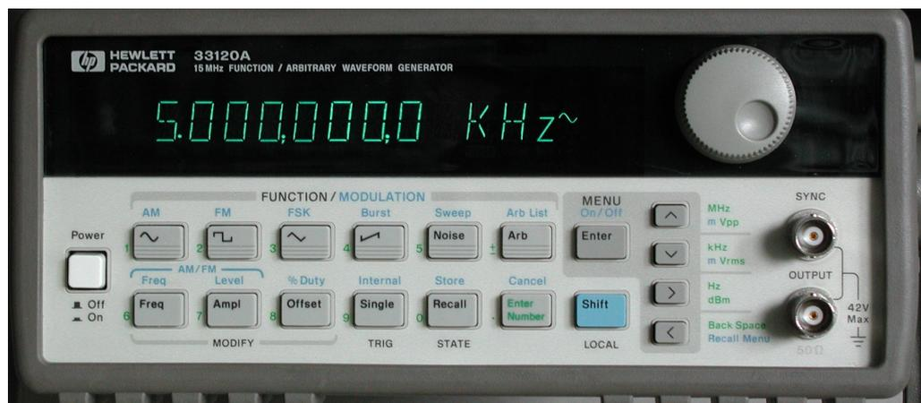
Als Signalgenerator wird das [Modell 33120A](#) der Firma [Agilent](#) [4] (früher: Hewlett Packard) eingesetzt. Neben einfachen Signalformen wie Sinus oder Rechteck kann der Generator auch lineare oder logarithmische Frequenz-Sweeps sowie amplituden- oder frequenzmodulierte Signale erzeugen. Darüber hinaus sind beliebige benutzerdefinierte Spannungsverläufe möglich. Die Maximalfrequenz beträgt 15 MHz.
