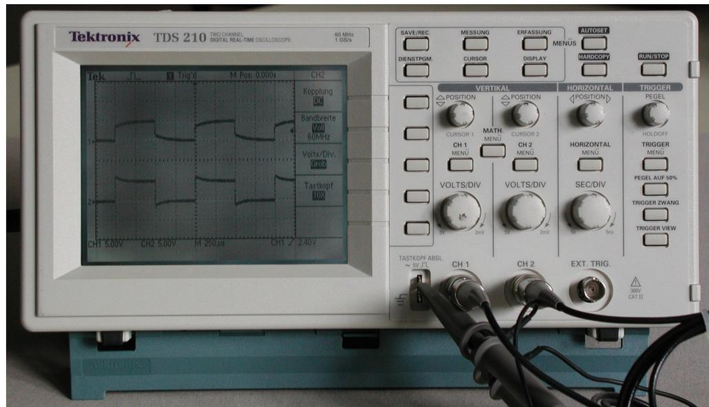
Das am Arbeitsplatz verwendete Oszilloskop TDS210 der Firma Tektronix[1] ist ein Digitalspeichergerät mit zwei Kanälen zu je 2500 Messpunkten, einer maximalen Bandbreite von 60 MHz, einer maximalen Abtastrate von 1 GHz und 8 Bit Amplitudenauflösung. Weitere technische Daten sind dem Benutzerhandbuch zu entnehmen [2].
