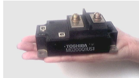
Abbildung 12: Baugrößen unterschiedlicher Transistoren. Links ein Kleinsignal-Transistor für Oberflächenmontage (Gehäuselänge 2.9 mm), zum Vergleich die Iberische Halbinsel auf dem 1-Euro-Stück. Rechts ein Hochleistungstransistor (maximale Kollektor-Emitter-Spannung 1200 V, maximaler Kollektorstrom 200 A).
